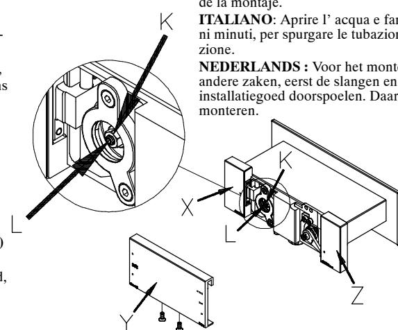
\* Når temperaturen er indstillet til den ønskede værdi, spændes møtrikken (K). (Husk at fastholde pinolskruen (L) ved hjælp at unbrakonøgle, når møtrikken (K) spændes).
